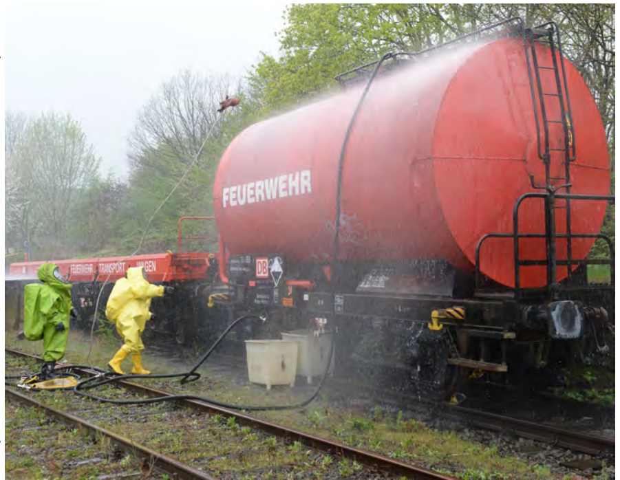
„Abdichtarbeiten am leckgeschlagenen Kesselwagen“
