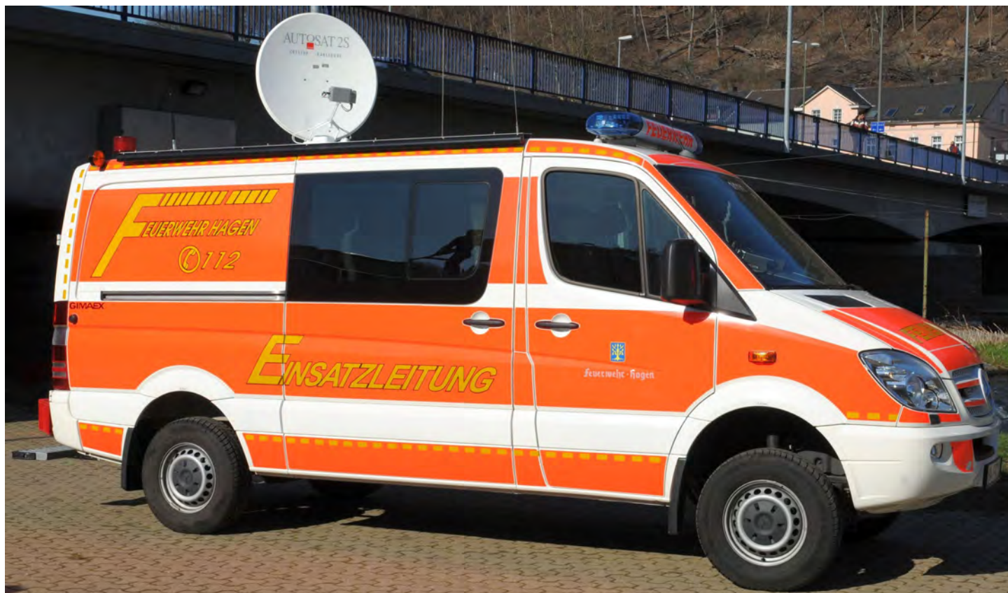
Der ELW mit dem automatisch ausgerichteten Sat-Spiegel
