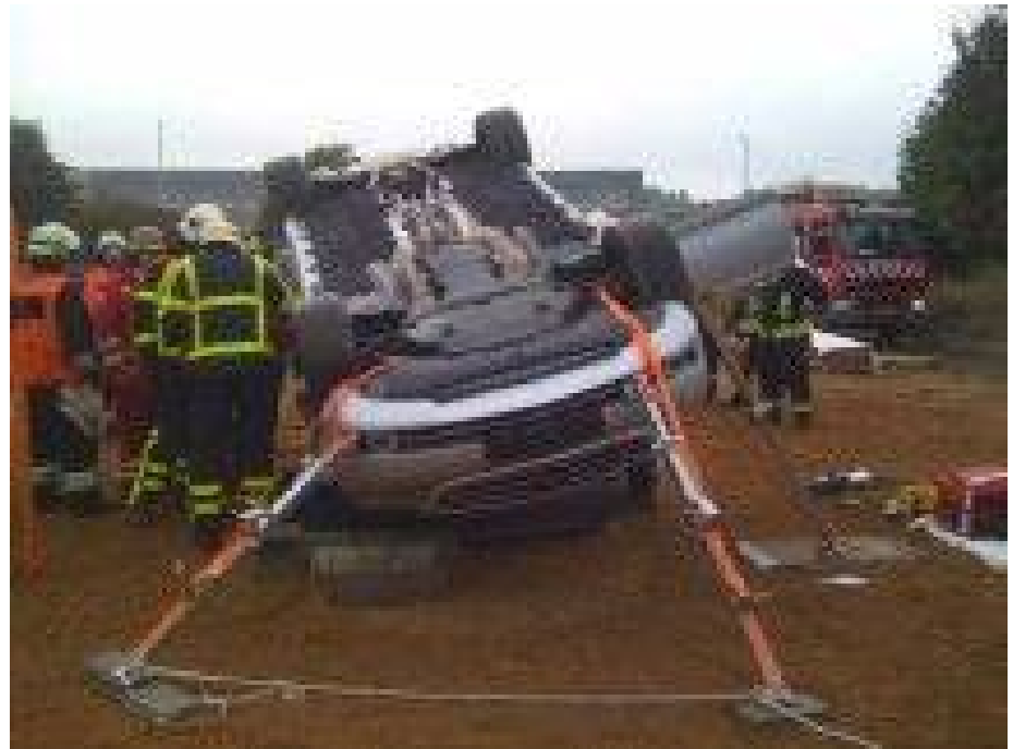
Pkw auf Dach, mit Stützmaterial gesichert.
